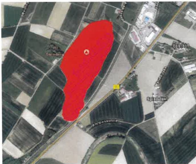
Abbildung 4: Gefahrenhinweiskarte zu Georisiken (hier: tiefreichende Rutschungen, Rutschanfälligkeit und Ablagerungsbereiche) aus BayernAtlas am 07.07.2023
