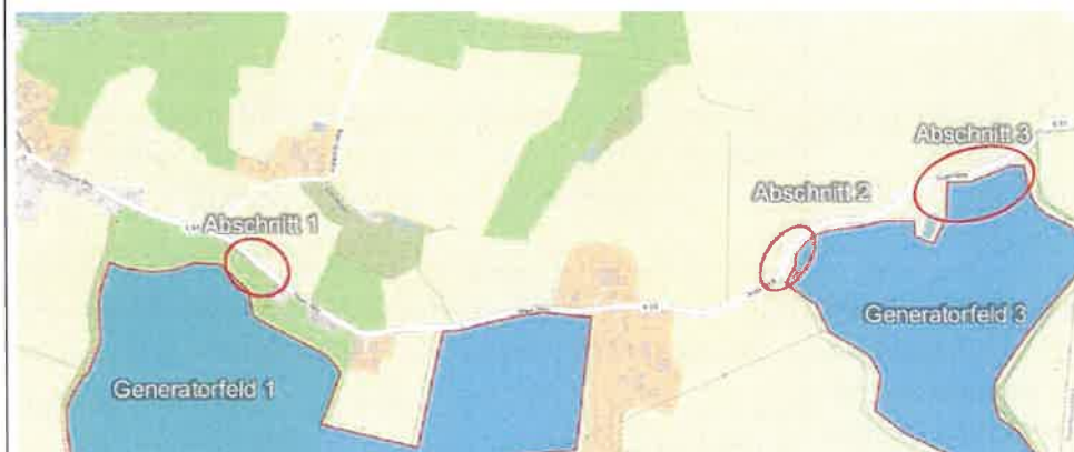
Abb. 35: Darstellung der Abschnitte mit relevanter Blendwirkung auf der K 61 (SONNWINN, 22.03.2023)
