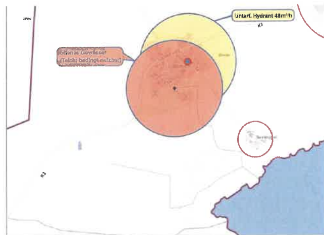
Abbildung 08: Löschwasserversorgung Lobkevitz, Neu Lobkevitz, Steinkoppel
