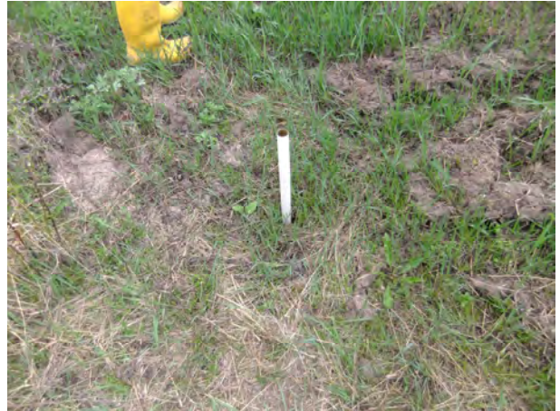
Messstab (2 m Länge) in Fallröhren versenkt
