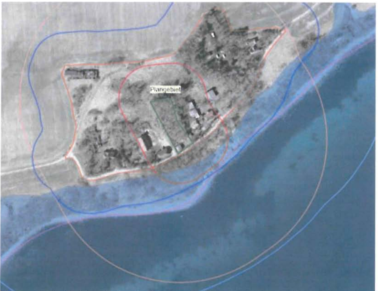
Wirkbereiche der bestehenden Beeinträchtigung des FFH-Gebietes (blaue Fläche) durch das Siedlungsgebiet des Weilers Goor (orange: Siedlungsgebiet, dunkelblau: 50m, hellblau: 200m) sowie die zu erwartenden Wirkbereiche des Vorhabens (grün: Vorhaben, dunkelrot: 50m, hellrot: 200m).
